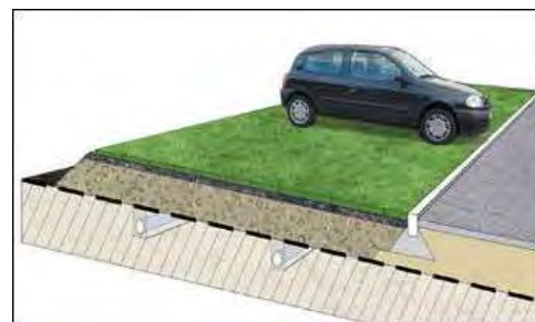
Parking en dalles engazonnées. L'utilisation de dalles engazonnées permet de retenir les eaux pluviales.
