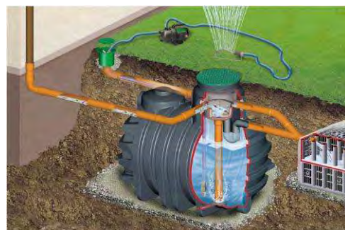
Cuve de rétentions des eaux pluviales. Ces cuves enterrées au droit des évacuations permettent une réutilisation des eaux pluviales.
